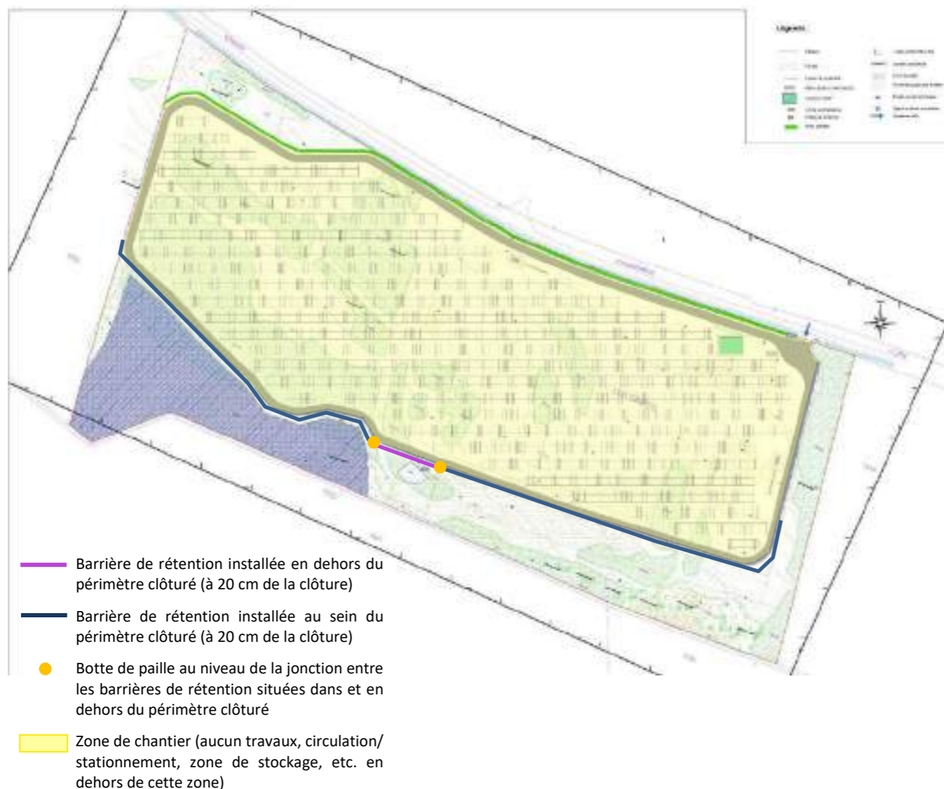
Figure 131 : Localisation des barrières de rétention temporaires et de la zone de chantier
